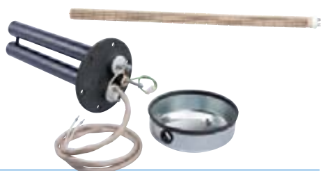
ТЭН МОДЕЛИ "RCER" НА ПЛАСТИНЕ: Фланцевый керамический ТЭН для водонагревателей CORAL VITRO "БАК-В-БАК", НАКОПИТЕЛЕЙ и моделей с теплообменником. Керамический ТЭН на эмалированной стальной пластине для бокового отверстия. Эмалированная стальная пластина + керамические ТЭНы для установки в боковое отверстие.
